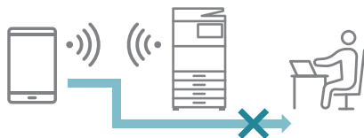
สมาร์ทโฟนหรือแท็บเล็ตไม่สามารถเข้าถึงระบบเน็ตเวิร์กภายใน (LAN) ของบริษัทผ่านเครื่อง MFP ได้
