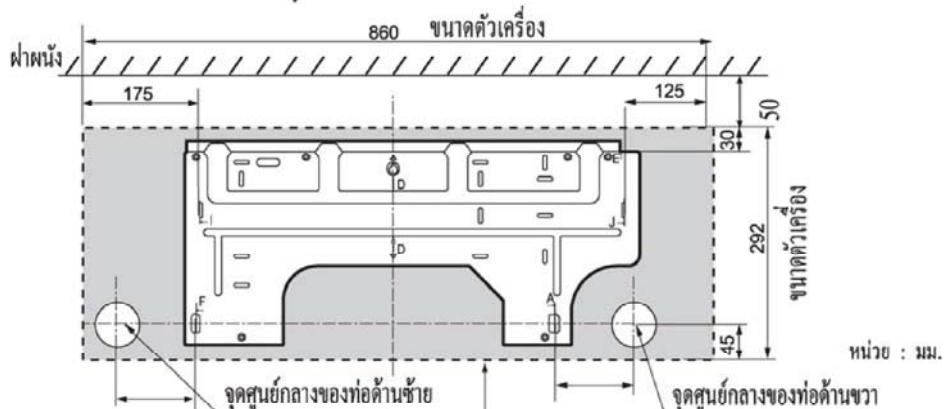
(2) เจาะรูขนาดเส้นผ่าศูนย์กลาง 6.5 มม. ลึก 32 มม. และตอกปลั๊กยึดผนังลงไปในรูที่เจาะ
