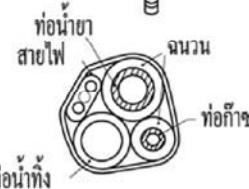
(3) พันท่อน้ำยา ท่อน้ำทึบ และสายไฟเข้าด้วยกันด้วยเทป
